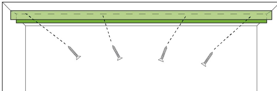
4. Choisissez de quel côté va se fermer la moustiquaire pour déterminer le côté de pose du coffre. Aligner 4 plaques de fixations (**D**) à la verticale d'un côté et vérifier à l'aide d'un niveau du côté où la moustiquaire va se fermer. C'est de ce côté que sera posé le profil de réception aimanté. Percer, puis fixer les plaques au mur avec les vis et chevilles.
